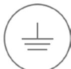
Die Liege muss außerdem zu einer externen angemessenen Äquipotential-Schutzschaltung (Sicherheitserdung) angeschlossen werden.
