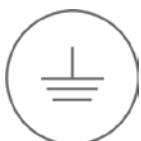
Die Liege muss außerdem zu einer externen angemessenen Äquipotential-Schutzsaltung (Sicheritserdung) angeschlossen werden.
