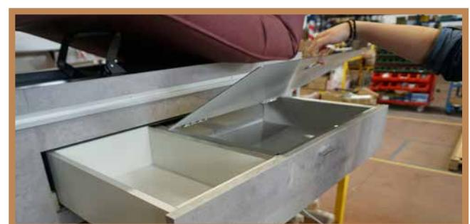
Öffnen Sie die Schuhblende vollständig, heben Sie das Panel der größeren Seite an (Achtung! Das Panel bleibt nicht geöffnet, Sie müssen es mit der Hand halten) und legen Sie die Handtücher ein, um sie zu erhitzen.
